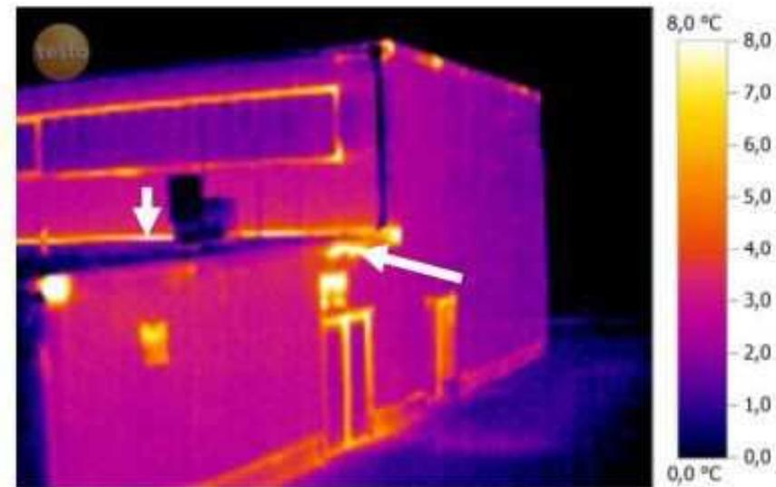
Nach Überdruck – Undichtigkeiten sind deutlich stärker erkennbar
